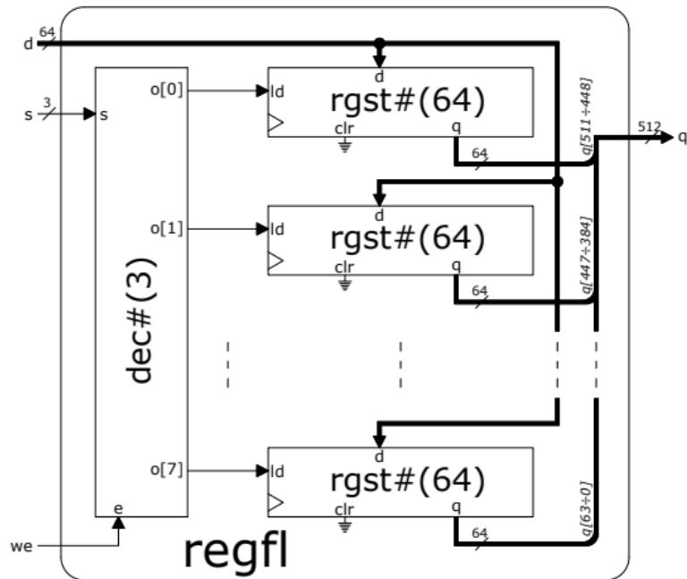
*dec#(3)* este o instanță a modulului *dec* disponibil [aici](#), parametrizată cu valoarea 3 pentru lațimea intrării de selecție.
